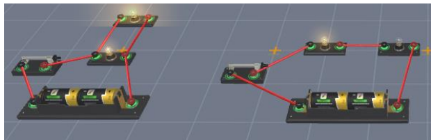
图 2 不同功率灯泡并串联连接
